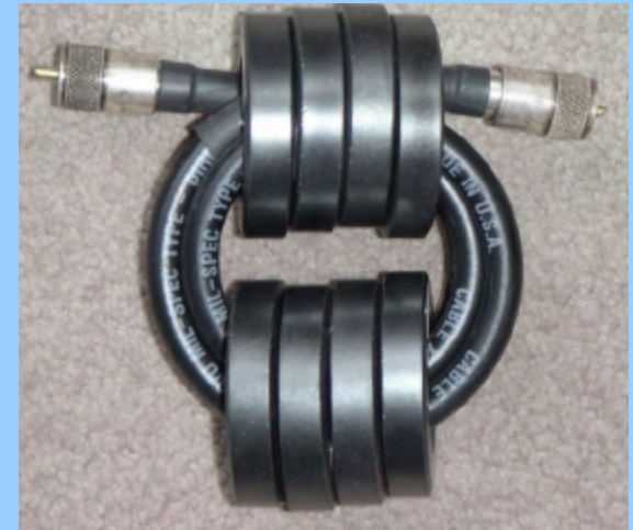
RG213 & tores mix 43 Impédance 1K de 1.8à18MHz
